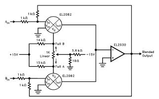
FIGURE 8. LINEARIZED GAIN CONTROL/FADER
